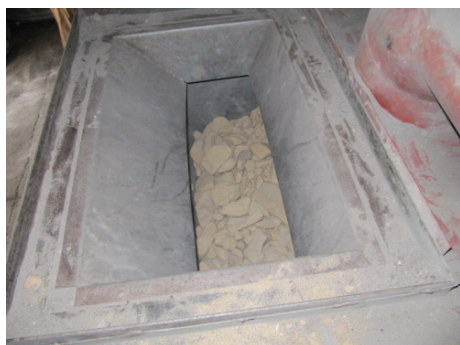
Rys. 2. Próba regeneracji przemysłowej mas z nowymi spoiwami nieorganicznymi (fot. I. Izdebska-Szanda)
