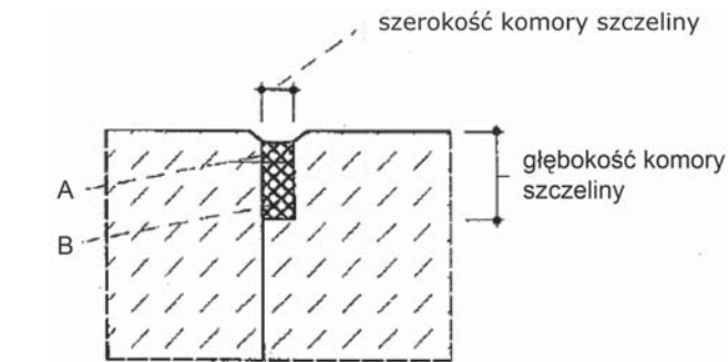
Oznaczenia: A – gruntowanie, B – zalewa.
