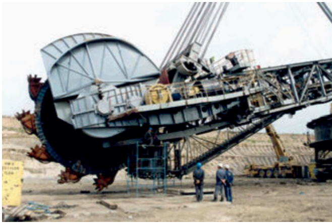
Rys. 1. Koło czerpakowe i fragment wysięgnika urabiającego koparki KWK 1500 [1] Fig. 1. Bucket wheel and bucket wheel boom section of BWE KWK 1500 [1]
