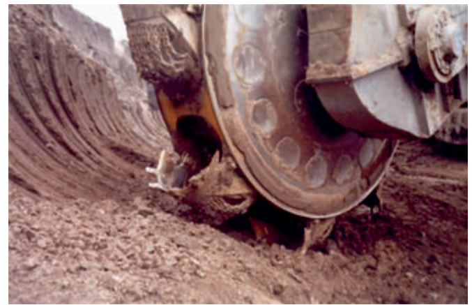
Rys.4. Koło bezkomorowe koparki SRs 1200 Fig. 4. Cell-less bucket wheel of BWE SRs 1200
