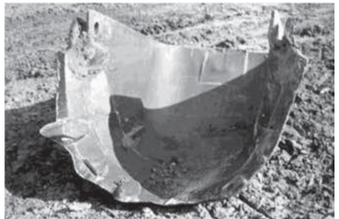
Rys. 8. Czerpak zużyty – widoczne wyłamania zębów i uszkodzenia noża [7]
