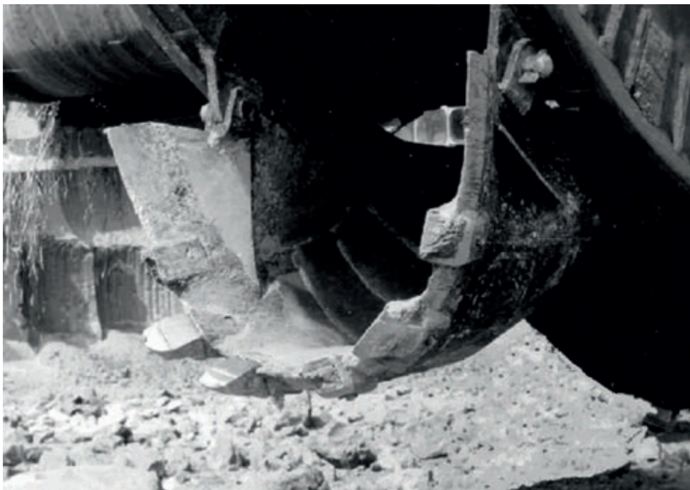
Rys. 9. Zużyte zęby przez ścieranie i wyłamania [7]
