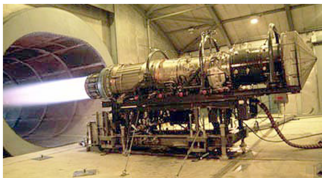
Rys. 1. Silnik odrzutowy F100-PW podczas prób
