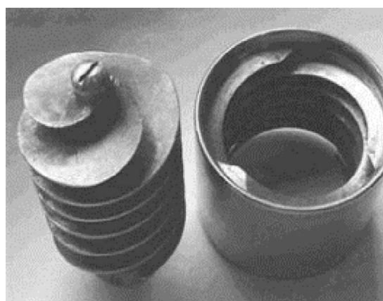
Rys. 4: Wstępny wirnik osiowy z bardzo wysoką zdolnością ssania (stopień osiowo-wirowy) [4]
