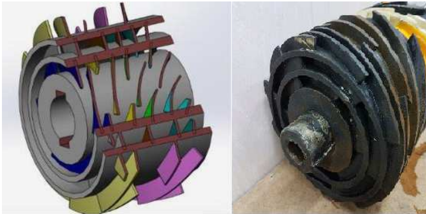
Rys. 9: Przykład wirnika polirzędowego: model 3D oraz obiekt rzeczywisty [3]
