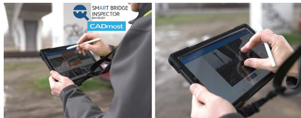
Rys. 6. Możliwość szkicowania i edycji zdjęć uszkodzenia podczas pracy w terenie
