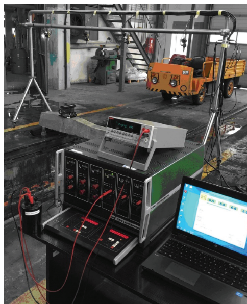
Rys. 4. Stanowisko do pomiaru rezystancji podkładów betonowych i systemów przytwierdzeń [fot. W. Surmak]
