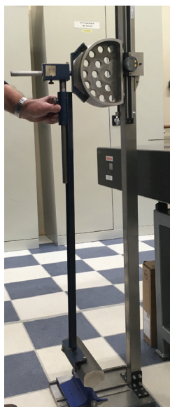
Rys. 3. Stanowisko do wzorcowania przyrządów do pomiaru wysokości osi zderzaka od główki szyny [fot. K. Bednaruk]
