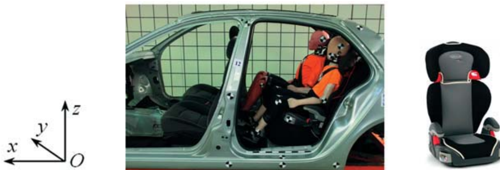
Rys. 4. Manekiny w nadwoziu samochodu i fotelik dla manekina P10
