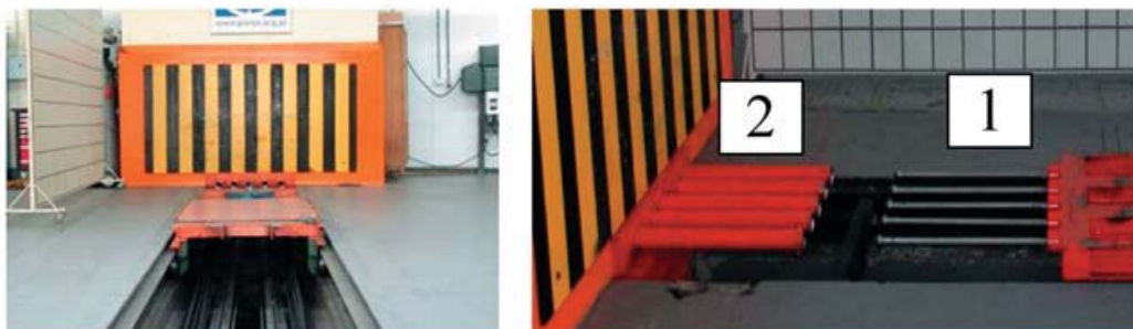
Rys. 3. Wózek i hamulec zderzeniowego stanowiska pomiarowego (PIMOT)
