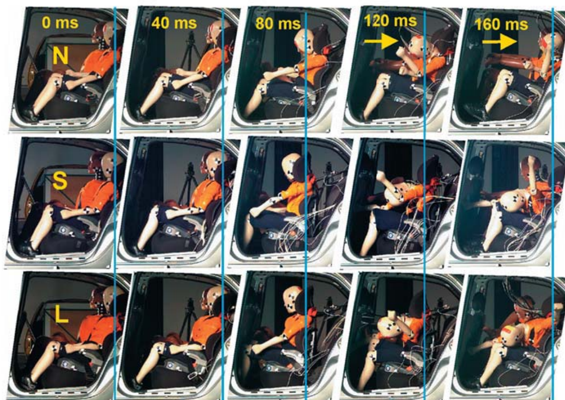
Rys. 12. Przemieszczenia manekina P10 w pomiarach N, S i L (pionowe linie poprowadzono przez znacznik na głowie manekina w pomiarze N, strzałki pokazują kierunek ruchu manekina w pomiarze N)
