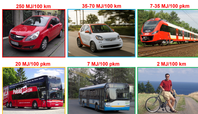
Rys. 12. Zużycie energii w megadżulach na 100 km na pasażera: samochód spalinowy z jedną osobą (spalanie 7 l/100 km), samochód elektryczny, pociąg/tramwaj (zapełniony w 3/4), autobus (zapełniony w 3/4), autobus elektryczny (zapełniony w 3/4) oraz rower. Zużycie energii w dużym aucie typu SUV to 500 MJ lub nawet więcej
