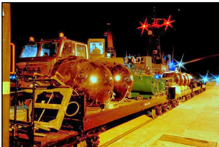
Rys. 2. Przykłady polskich min morskich, od lewej OD, MMD i OS Źródło: www.zoom.mon.gov.pl .
