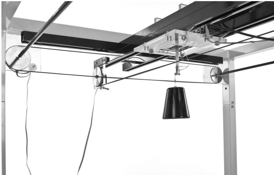
Rys. 1. Model laboratoryjny suwnicy pomostowej sterowanej z komputera PC [10]
