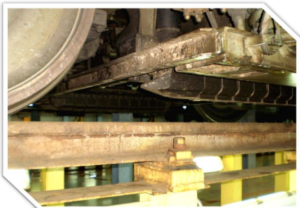
Rys. 9. Płoza hamulca magnetycznego zawieszona nad szyną [źródło: opracowanie własne]
