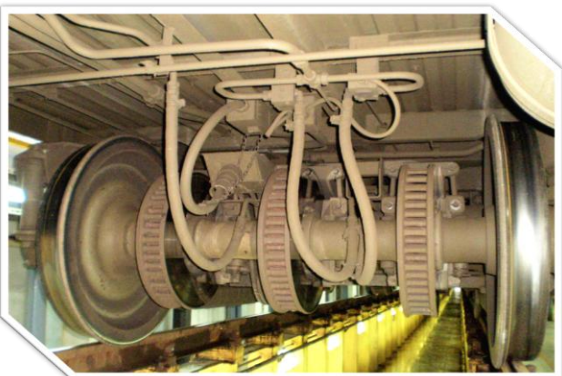
Rys. 8. Kabel zasilający hamulec szynowy na wózku [źródło: opracowanie własne]
