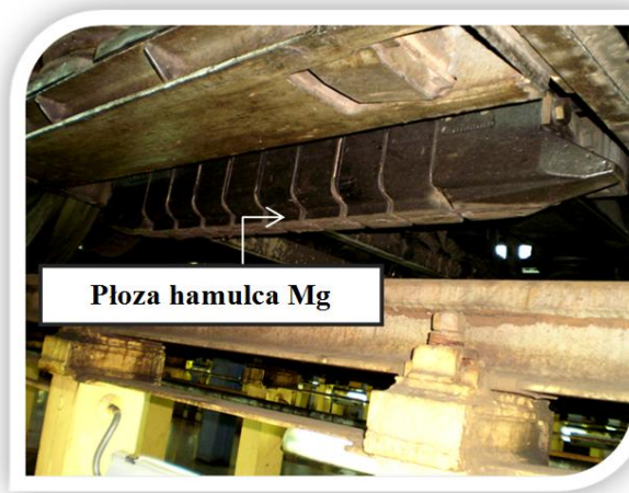
Rys. 4. Płoza hamulca magnetycznego [źródło: opracowanie własne]
