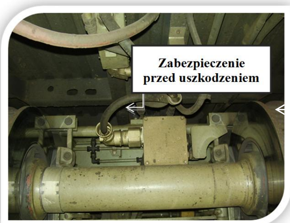
Rys. 3. Zabezpieczenie przed uszkodzeniem [źródło: opracowanie własne]
