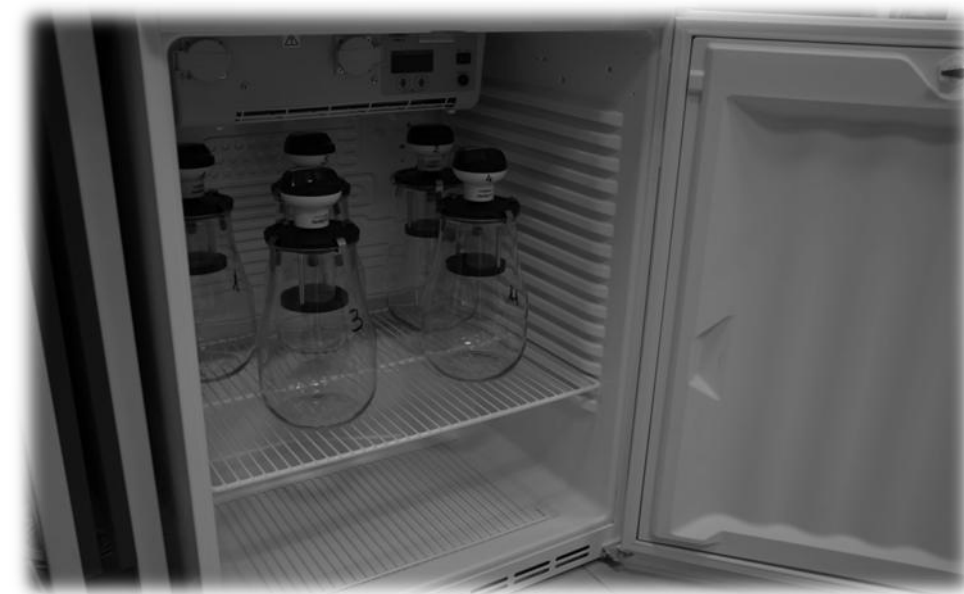
Rys. 2.1 Szafa termostaticzna zawierająca zestaw OxiTop Control do oznaczania parametru AT_4
