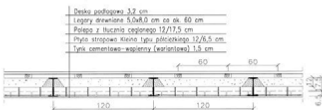
Ryc. 3. Przekrój prostopadły przez strop Źródło: Opracowanie własne.
