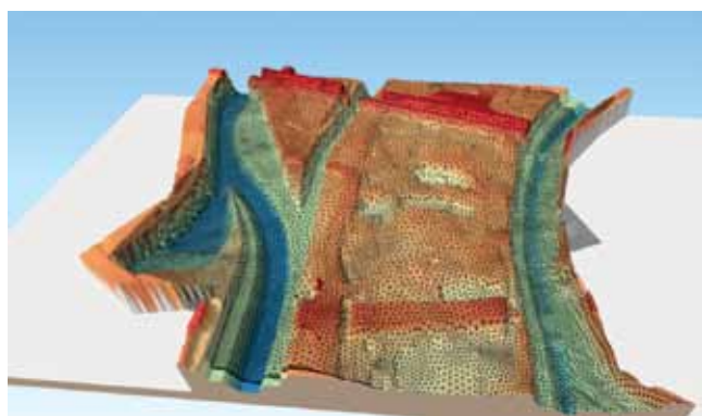
Rys. 8. Fragment siatki podziału metody elementów skończonych Poznańskiego Węzła Wodnego
