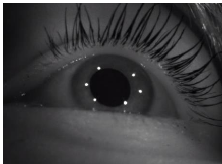
Rys. 1. Zdjęcie lewego oka wykonane eyetrackerem SMI Eye Tracking Glasses 2.0 z wyraźnie zaznaczoną czarną źrenicą oraz odbiciami na rogówce 6 źródeł światła Мал. 1. Фото лівого ока зроблене eye trackerem SMI Eye Tracking Glasses 2.0 з чітко зазначеною чорною зіницею і відбитими на рогівці 6 джерелами світла
