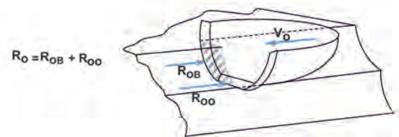
Fig. 4. Cutting of plastic soils diagram [2] Rys. 4. Schemat urabiania (skrawania) gruntów plastycznych [2]
