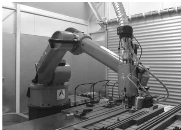
Fig. 2. A robot controlling a laser-hardening head Rys. 2. Robot sterujący głowicą hartującą laserowo
