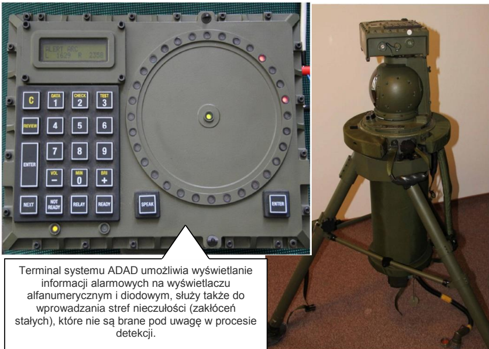
Rys. 2. Główne elementy systemu ADAD w wersji przenośnej (Źródło: opracowanie własne)
