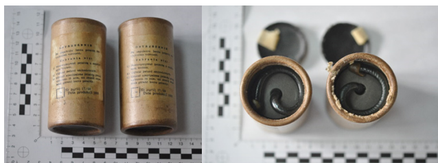
Rysunek 2 Oryginalna petarda wojskowa z zapalnikiem lontowym (fot. autora)
