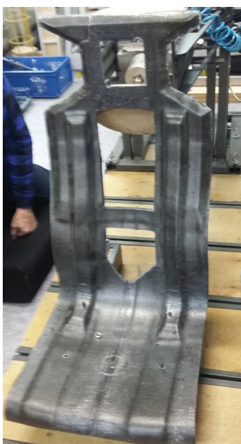
Rys. 6. Kompozytowa skorupa nośna fotela z wyciętymi otworami [fot. autorów]
