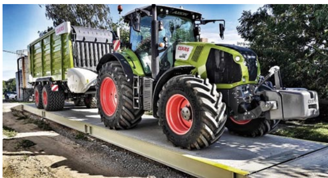
Rys. 2. Waga najazdowa 18 m; pomosty zespolone
