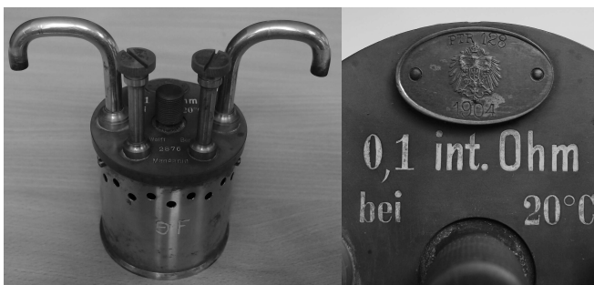
Rys. 2. Rezystor normalny 0,1 \Omega z cechą legalizacyjną PTR z 1904 r. [2]
