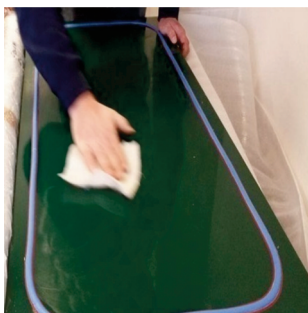
Rys. 1. Nałożenie wosku "Spracewax 300" na powierzchnię przygotowanej formy
