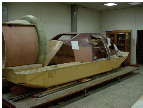
Rys. 12. Kompozytowy kadłub poduszkowca PRC-600
