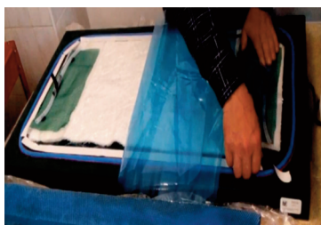
Rys. 5. Suche wzmocnienie w metodzie infuzji przykryte delaminażem, materiałem "oddychającym", oraz siatką z przyklejaną folią do dwustronnej taśmy uszczelniającej na obwodzie formy
