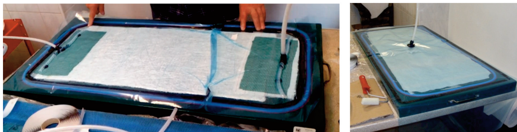
Rys. 6. Sprawdzenie instalacji na szczelność w metodzie infuzji (a) i worka próżniowego (b)
