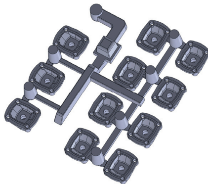
Rys. 11. Technologia odlewania pokrywy Fig. 11. Lid casting process
