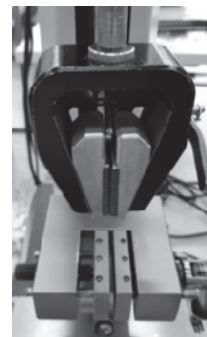
Rys. 3. Uchwyt urządzenia do pomiaru sił zrywania i rozwarstwiania połączonych przewodów oraz przykładowy pomiar siły zrywania w funkcji położenia
