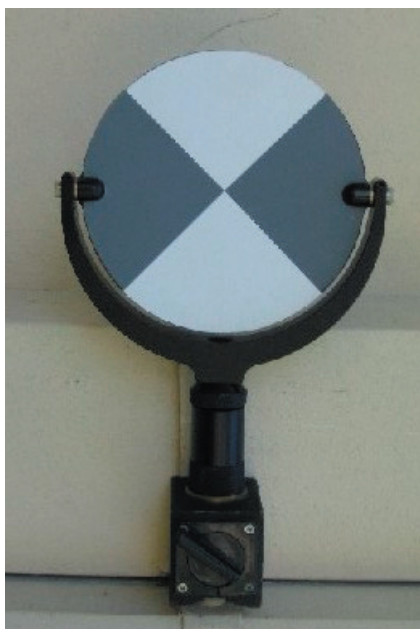
Rys. 2. Widok tarczy/znacznika wykorzystywanego do łączenia skanów
