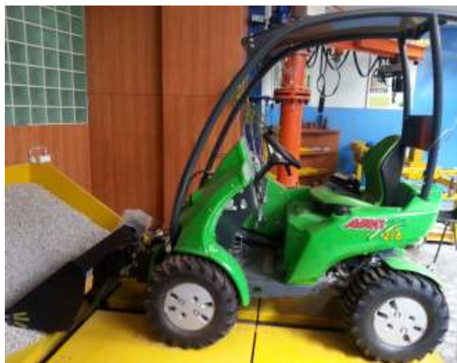
Rys. 1. Stanowisko do badania procesu ładowania łyżką ładowarki z ładowarką łyżkową Avant 218
