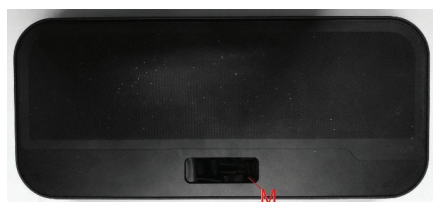
Fot. 2. Ultradźwiękowy przetwornik haptyczny STRATOS Inspire; M – moduł śledzenia dłoni (źródło: CIOP-PIB)
