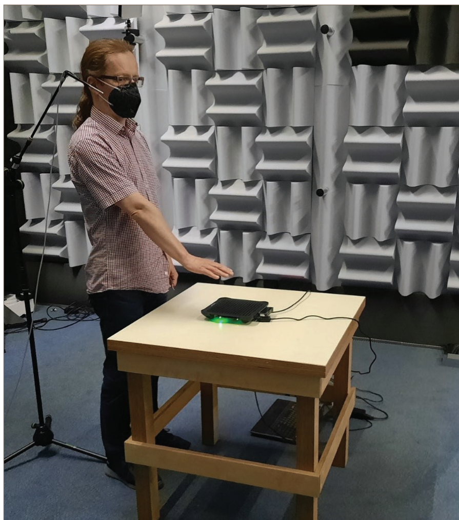
Fot. 3. Stanowisko badawcze i osoba obsługująca ultradźwiękowy przetwornik haptyczny w trakcie badań (źródło: CIOP-PIB)
