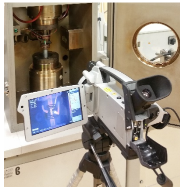
Rys. 6. Próbką podczas badań w komorze plastometru skrętnego
