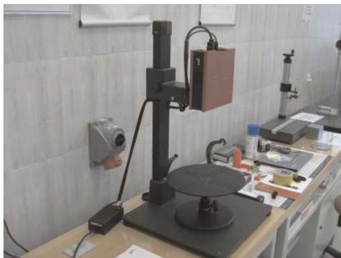
Rys. 3. Wykorzystywany w badaniach skaner 3D typu ATOS CORE 200 produkcji GOM GmbH
