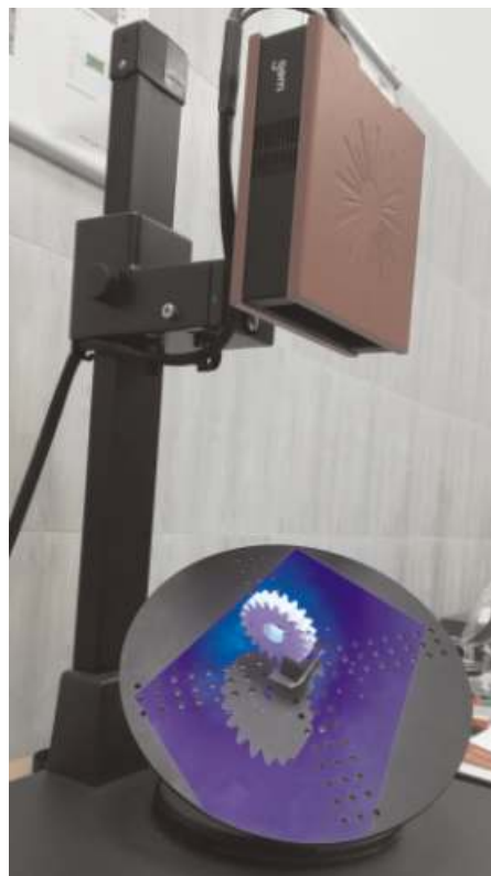
Rys. 7. Pomiary wydrukowanego koła zębatego za pomocą skanera 3D typu ATOS CORE 200 produkcji GOM GmbH
