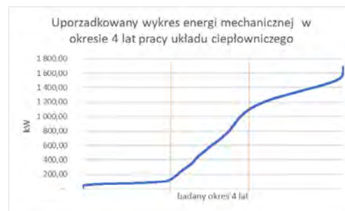
Rys. 8. Uporządkowany wykres energii mechanicznej wody sieciowej
