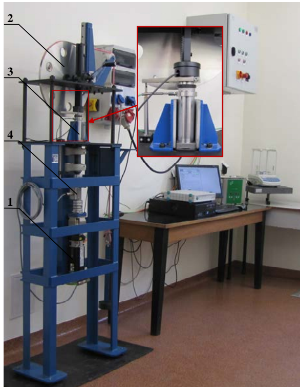
Rys. 2. Ogólny widok stanowiska badawczego zbudowanego przez Instytut Technologii Eksploatacji – Państwowy Instytut Badawczy w Radomiu z zamontowanym testowym węzłem tarcia (3), krążkiem obciążnika (2), czujnikami siły i momentu (4) oraz napędem (1)
