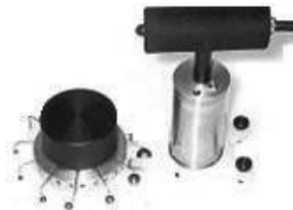
Rys. 8. Zestaw młotczków do wzbudzania fal sprężystych [1, 18]
