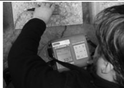
Rys. 11. Prace podczas sprawdzania detektorem zbrojenia trójwarstwowych próbek
