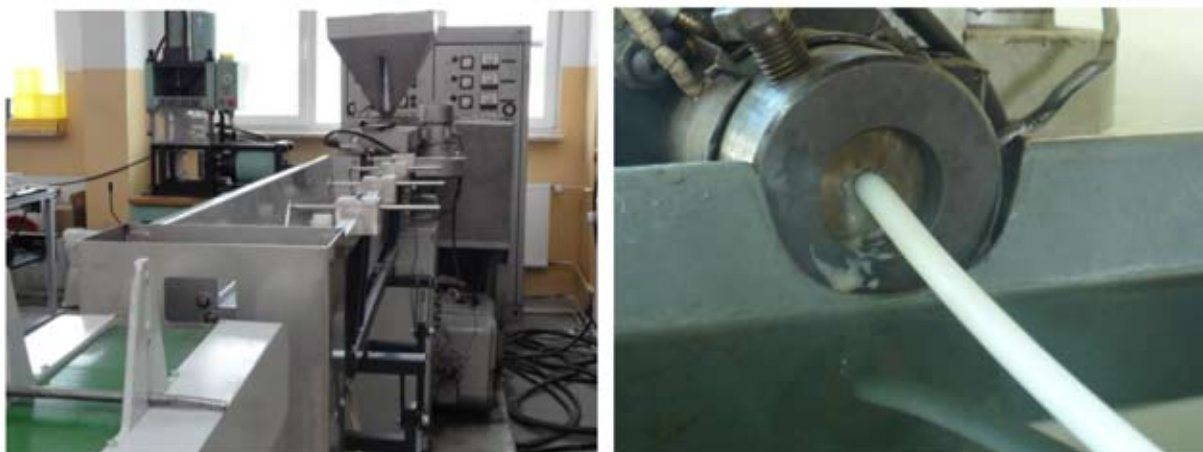
Rys. 1. Wygląd fragmentu linii technologicznej wytłaczania porującego oraz wytwarzanej rurki
