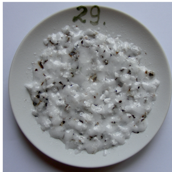
Fot. 12. Wypał próbki granulacji 3,0-5,0 mm z gnejsu jasnego bez separacji magnetycznej Fot. 12. Calcination of light-coloured gneiss sample (grain size 3.0-5.0 mm) without magnetic separation
