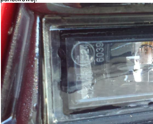
Rys. 1. Przykład oznakowania świateł dziennych (z opcją świateł pozycyjnych)
