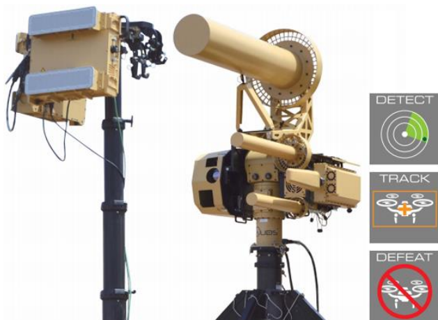
Fot. 1. System do przechwytywania BSP AUDS (Anti-UAV Defence System) brytyjskiej firmy Blighter Surveillance Systems Ltd. [2]
