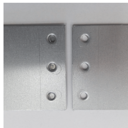
Rys. 10. Przykład zerwanej próbki wykonanej z blachy o grubości 0,7 mm bez lakierowania
