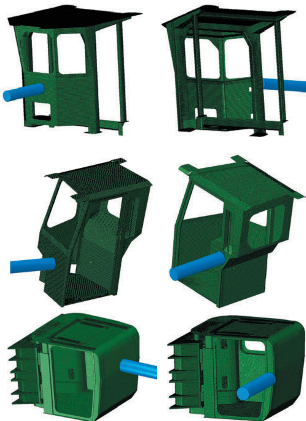
Rys. 3. Symulacja numeryczna wyrzutu skały z ociosu w poszycie boczne (po lewej) oraz słup konstrukcji chroniącej (po prawej)
