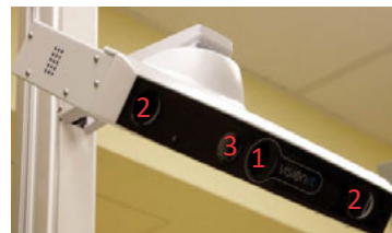
Rys. 1 (górny) Rozmieszczenie trzech paneli optycznego systemu obrazowania w bunkrze akceleratora; (dolny) panel zawierający projektor (1), dwie kamery cyfrowe (2), dodatkowe źródło światła korygującego szumy (3) Źródło: Archiwum własne.
