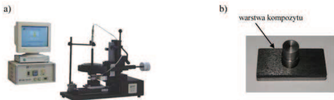
Rys. 3. Widok testera tribologicznego (a) i skojarzenia badawczego (b)
