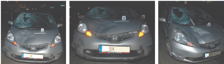
Ryc. 16. Uszkodzenia samochodu Honda Jazz.
