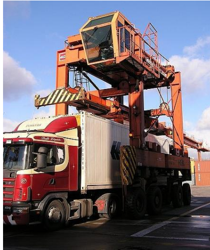
Rys. 7. Wóz kontenerowy podsiębierny wykorzystywany w BCT Gdynia Źródło: http://www.bct.gdynia.pl/galeria/infrastruktura-bct .
