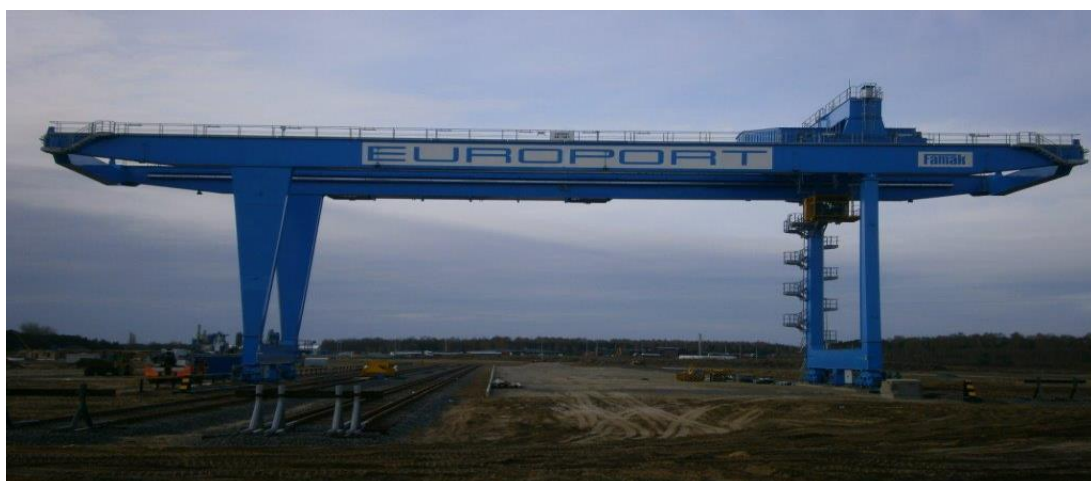
Rys. 4. Suwnica bramowa kontenerowa o udźwigu Q=40/50 t firmy FAMAK Źródło: http://famak.pl/famak/pl/.php?option=com_zoo&task=category&category_id=26&Itemid=153 .
