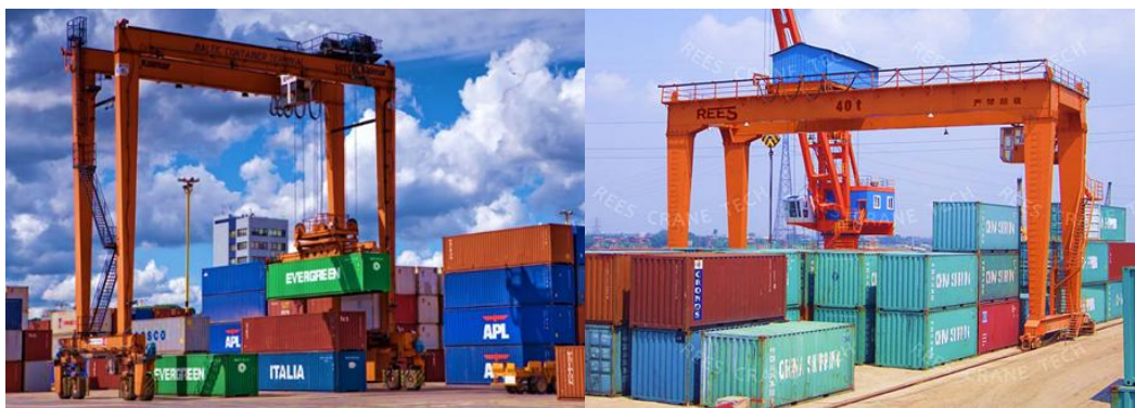
Rys. 6. Przykładowa suwnica placowa typu RTG i RMG
