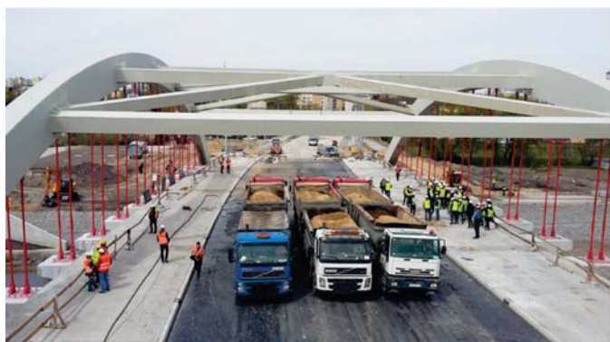
Fot. 4. Ustawienie ciężarów próbnych na moście: a) widok z góry, b) widok z poziomu jezdni
