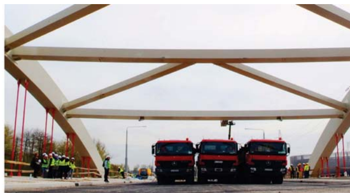
Fot. 4. Ustawienie ciężarów próbnych na moście: a) widok z góry, b) widok z poziomu jezdni
