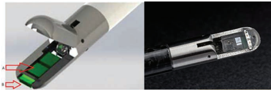
Rysunek 5. Narzędzie mechatroniczne z czujnikiem siły znajdującym się na końcu narzędzia
