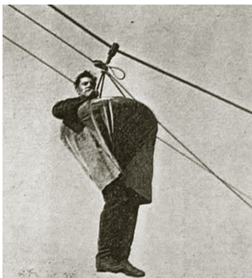
Ryc. 5. Ewakuacja za pomocą hosenboje [1], [5-6] Fig. 5. Evacuation with use of a breeches buoy [1], [5-6]
