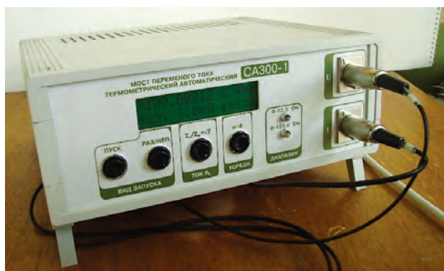
Rys. 4. Automatyczny mostek AC typu CA 300
