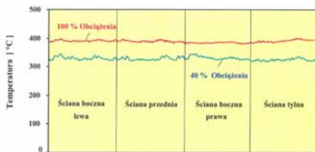
Rys. 7. Temperatura czynnika na wylocie z rur spiralnych przy różnych obciążeniach kotła
