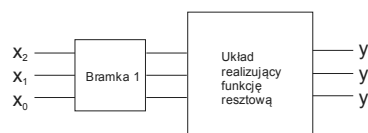
Rys. 4. Początkowa dekompozycja układu Fig. 4. Initial decomposition of the circuit
